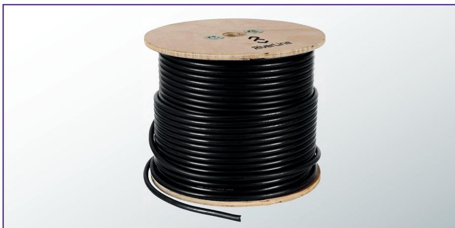
EL cable coaxial Hipercoax RG6-RXT está pensado, diseñado y desarrollado para cumplir con los requerimientos de RITEL (Res 5405 de 2018, Res 5993 de 2020, Res 6771 de 2022). Su conductor interior está fabricado en acero cobreado (CCS) al 21%, garantizando buen desempeño en las frecuencias de 470 a 698 MHz y siendo costo eficiente para el mercado colombiano. Tiene una cubierta PE con alta resistencia a la humedad siendo ideal para un uso exterior.
